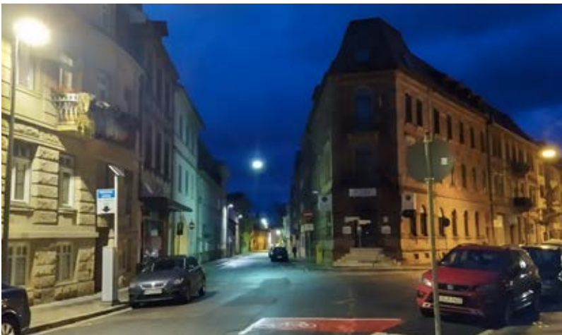
Aufzweigung Friedrich-Ebert-Straße / Hindenburgstraße mit aktuell drei verschiedenen Lichtfarben: WW, KW, Orange
